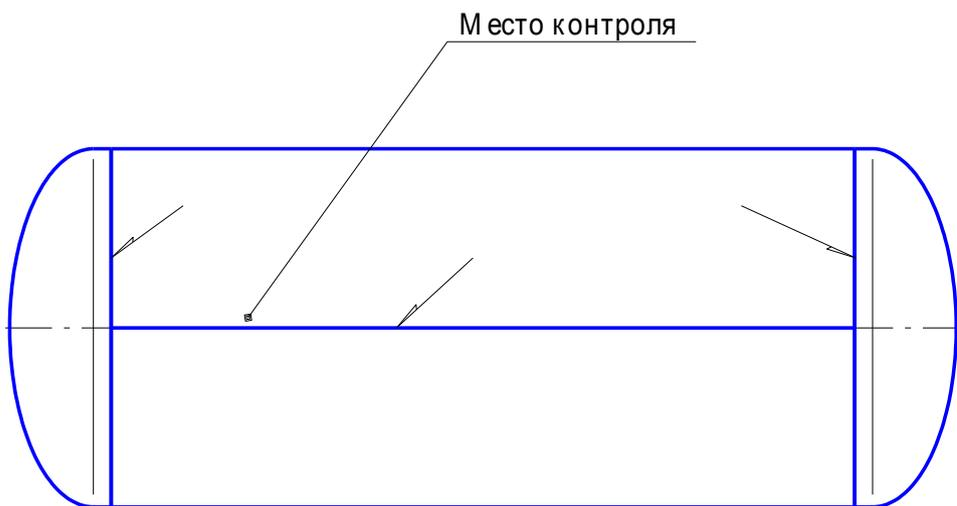
Рис. 4. Эскиз сварных соединений с указанием места контроля
